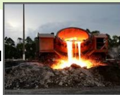
(6) Basculamento da escória no Pátio de apagamento
