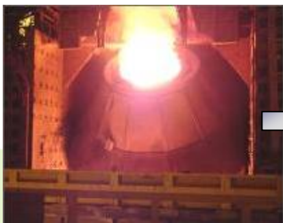
(1) Convertedor inclinado pronto para receber a sucata e o gusa líquido
