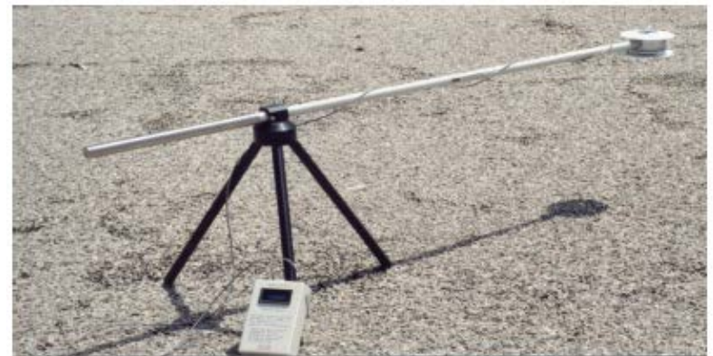
Pyranometer (ASTM E1918, LBNL E1918A)
